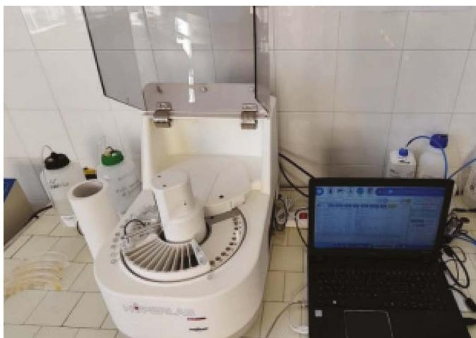
Fig 1: analizzatore enzimatico Hyperlab Smart con apposito pc per la programmazione della macchina
